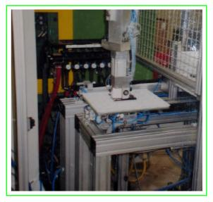
Tray ab Stapel vereinzeln, mit AQS-Roboter aufnehmen und in Karton einlegen
