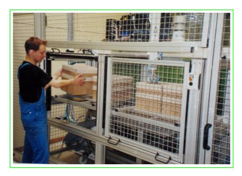
Gefüllte Kartons aus Verpackungsstation entnehmen, leere Kartons einlegen. Während dem Kartonwechsel befüllt der Roboter die Kartons auf der rechten Seite der Station.
